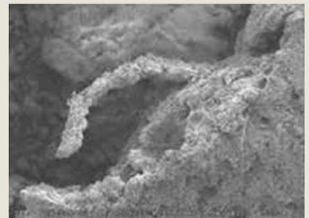
Fig. C: Fibra de celulosa unida con la pasta de cemento.
